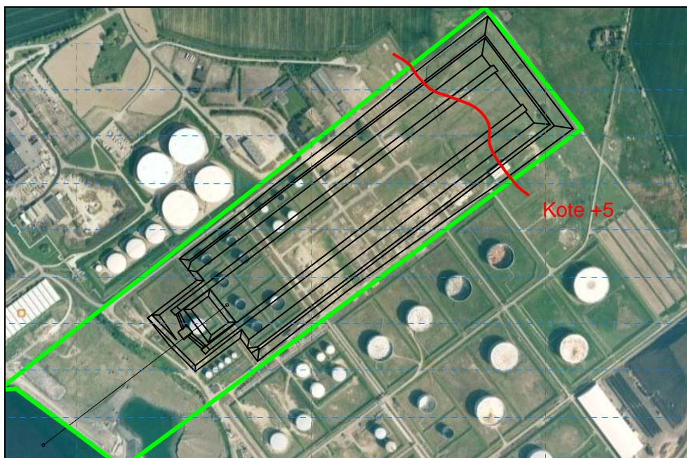
Figur 16: Luftfoto med angivelse af forventet opbygning af jordvolde. Desuden er højdekurven i kote 5 angivet.
