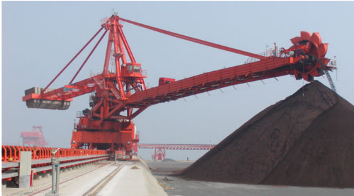
Figur 14: Billede af en stacker/reclaimer. Da de stacker/reclaimere, der skal anvendes på lageret i Stignæs, ikke er ordret endnu, kendes det præcise design af maskinerne endnu ikke.
