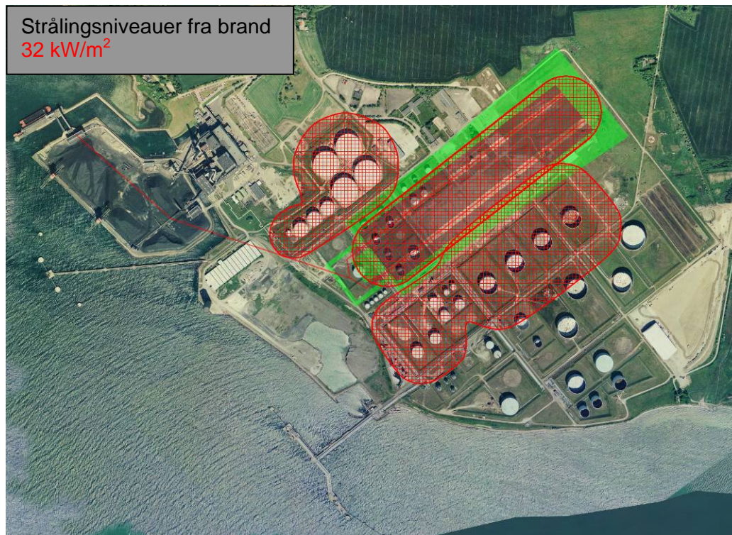
Figur 33: Område (markeret med rødt) med en strålingsintensitet på mindst 32 \text{ kW/m}^2 fra worst case brand i hele kullageret og worst case pølbrand omkring nærliggende tanke ved en vindhastighed på 11 \text{ m/s} .
